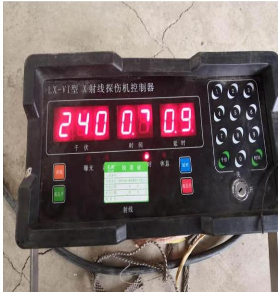
照片 16 探伤机延时开机装置
